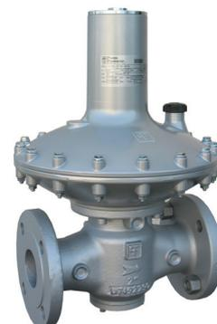
**Dival 600** rientra nella gamma dei **regolatori di pressione del gas ad azione diretta** con comando a membrana e contrasto a molla di Pietro Fiorentini. Principalmente impiegato nella realizzazione di reti per la distribuzione a media e bassa pressione del gas naturale, può essere utilizzato con fluidi gassosi preliminarmente trattati. Secondo la norma europea EN 334, è classificato come **Fail Open**. Dival 600 è **Hydrogen Ready** per blending GN-H2.
