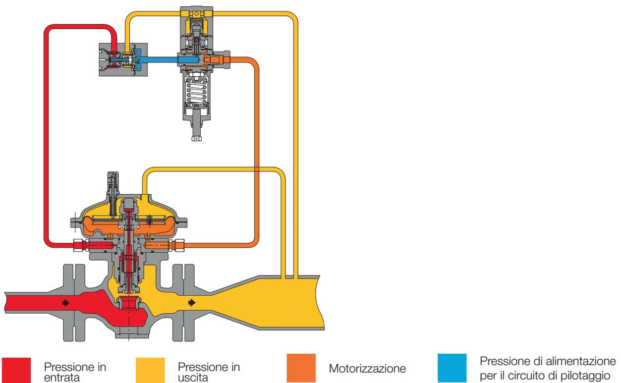
**Figura 7** Dixi con pilota fail-to-open serie 210
