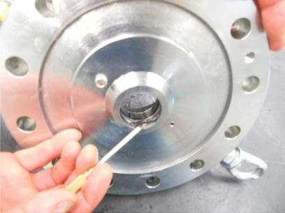
23. Mediante apposito attrezzo, rimuovere e sostituire l'IDWR (41)
