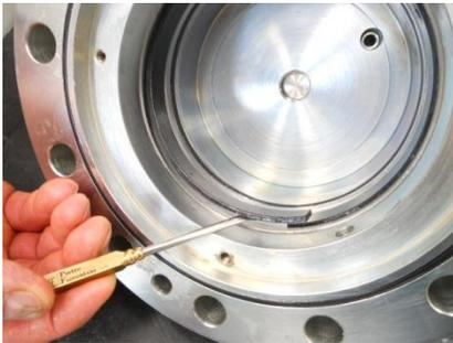
16. Appoggiare sulla superficie di lavoro il guida otturatore (3) e rimuovere la vite di fissaggio (43) e la relativa rosetta (42)
