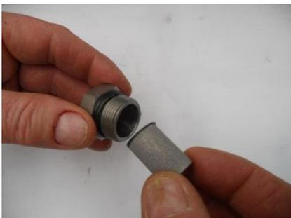
24. Rimuovere e sostituire le guarnizioni (22), nonché il filtro (32)
