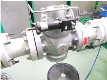
2. Dopo aver svitato il dado di fissaggio del raccordo (23), scollegare l'impulso della pressione di comando
