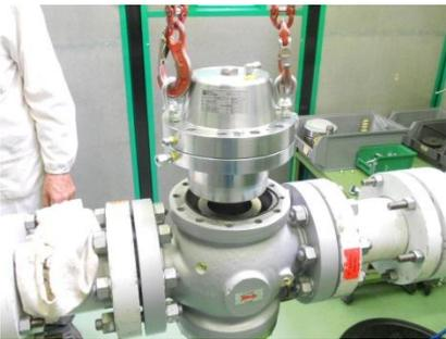
8. Svitare e rimuovere le viti di fissaggio (73) del coperchio al guida otturatore
