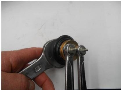
15. Dopo aver rimosso il pistone (31) e il disco protezione pilota (12), rimuovere e sostituire la membrana (25)
