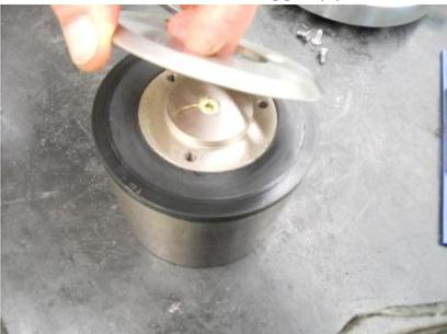
26. Rimuovere e sostituire la guarnizione armata (7)
