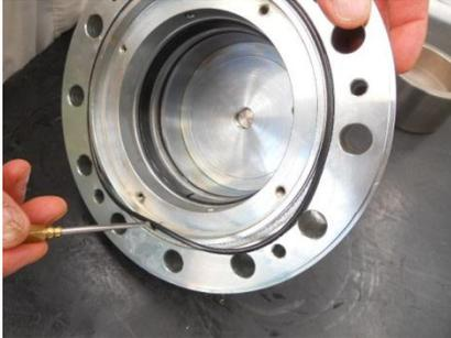
15. Mediante apposito attrezzo, rimuovere e sostituire l'IDWR (38)
