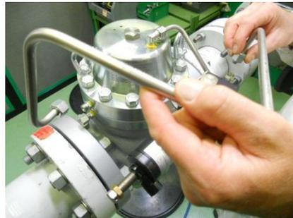
4. Rimuovere il pilota, svitando la relativa vite di fissaggio
