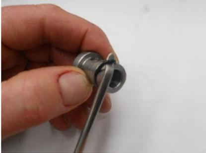
21. Rimuovere e sostituire la guarnizione armata (7)
