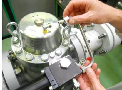
3. Dopo aver svitato il dado di fissaggio del raccordo (75), scollegare l'impulso della pressione di motorizzazione
