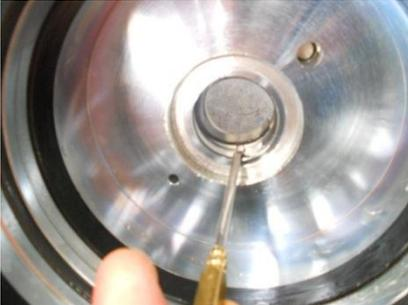
24. Dal supporto guarnizione (6), svitare e rimuovere le viti di fissaggio (17)
