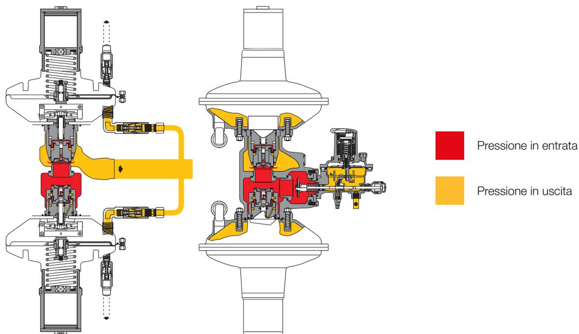
**Figura 3** Trias BM con monitor e blocco
