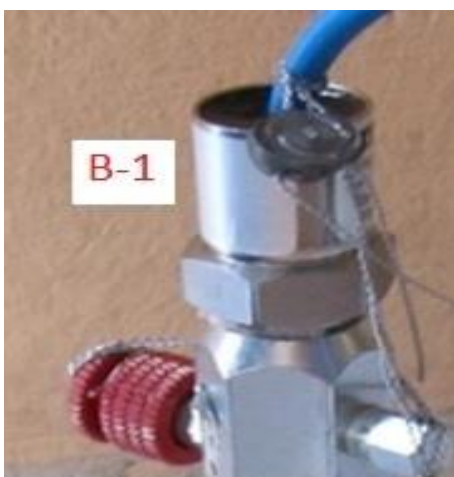
Figura11: Sigillo di Tipo B trasduttore di pressione
