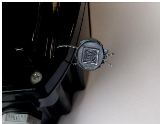
Figura 15: Sigillo hardware non metrologico sul coperchio di MODUS
