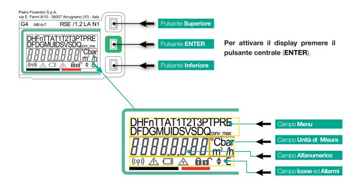
**All'attivazione verrà eseguito un test del display**, al termine del quale verrà visualizzato il menù con il totalizzatore dei volumi alle condizioni di riferimento.
