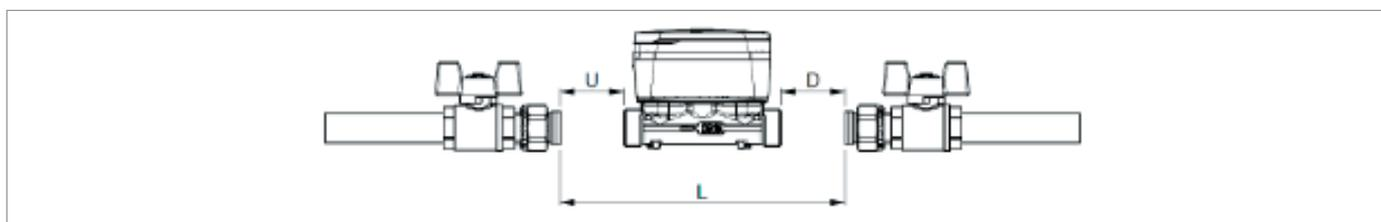
Fig. 7.9. Distance entre le compteur SSM-AQUO et les joints
