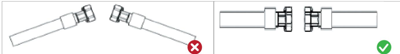
Fig. 7.7. Alignement incorrect des tuyaux
