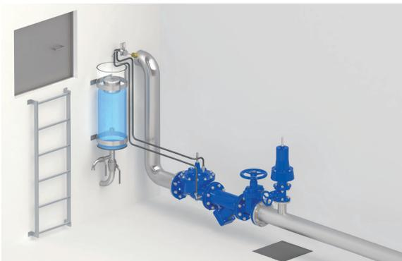
**Control de nivel.** En las instalaciones con válvulas automáticas de control de nivel de los depósitos, sobre todo cuando se gestionan los niveles mínimos y máximos, existe un riesgo importante de sobrepresión durante la fase de cierre de la válvula.
