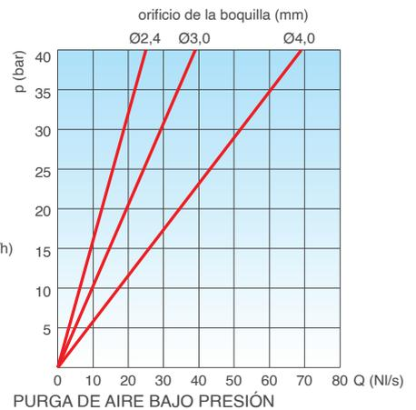
Las curvas de capacidad se crearon en Kg/s según pruebas de laboratorio y análisis numérico, sin malla, y reconvertidas en Nm³/h con un factor de seguridad.
