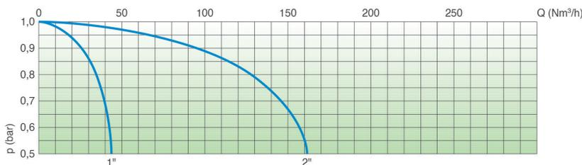
CAUDAL DE AIRE DE ENTRADA PARA EL VACIADO DE LA TUBERÍA
