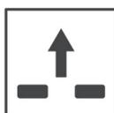
**Versione SERIE EO solo uscita**, disponibile per i modelli WAVE LP90 2S e 3S. Questa variante è stata progettata per permettere l'installazione dello sfiato in punti critici del tracciato in cui la piezometrica sia più bassa rispetto al profilo, con funzionamento quindi in depressione, e in ogni altro nodo dove, per necessità progettuali, debba essere assolutamente evitato il rientro d'aria.
