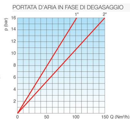
Le curve delle portate sono ottenute in Kg/s da prove di laboratorio e analisi numeriche, senza filtro, e convertite in Nm³/h applicando un adeguato fattore di sicurezza.
